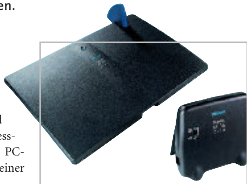
SIEMENS GIGASET 3070 ISDN: Basis-Station als schnurlose Zentrale zum Anschluss von Telefonen und/oder Datenmodulen.
