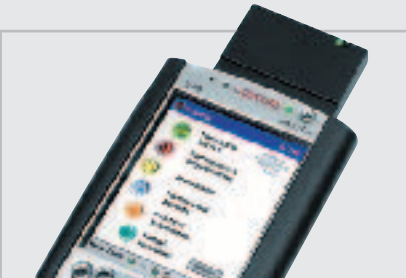
DAVOS COMPANION: Ein Software-modifizierter Compaq iPaq samt Wireless-LAN-Modul als aktuelle Informationsquelle.
