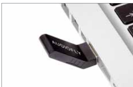
Der kleine USB-Dongle befähigt jeden Computer, den Ton an einen Audiofly-Empfänger senden zu können
