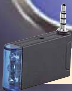
Der Infrarotadapter besitzt einen eigenen LiPo-Akku – gut für die Laufzeit des iPhones
