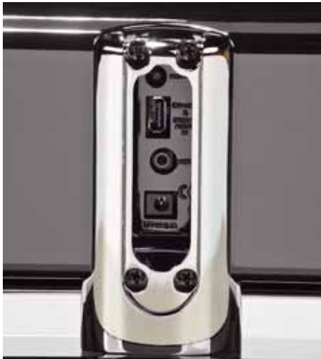
Auf der Rückseite befinden sich Anschlüsse für einen analogen Zuspeler und iPad/iPhone
