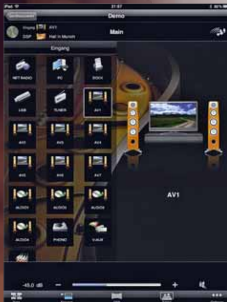
Auf einem Tablet, wie hier auf einem iPad gezeigt, lassen sich die angeschlossenen Geräte mit der AV-Controller-App sehr bequem steuern
