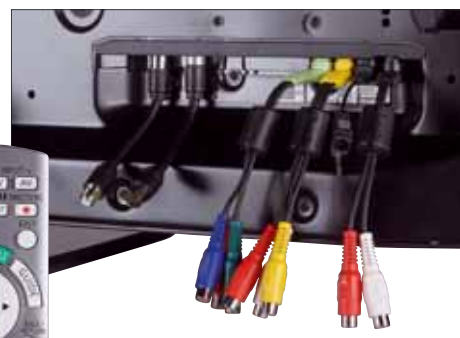
Panasonic liefert für etliche Schnittstellen Adapterstücke (z.B. analoge Eingänge und S/PDIF-Ausgang) mit
