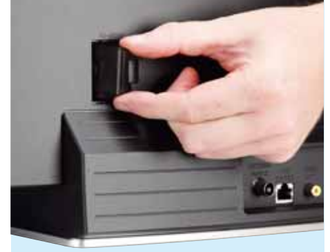
Der Bluetooth-Dongle ist unter einer Klappe versteckt. Falls kein WLAN vorhanden ist, hat die Pioneer zur Sicherheit einen herkömmlichen LAN-Anschluss. Die Antennenbuchse ist für den UKW-Empfang, daneben ist der Videoausgang gut zu erkennen. Der wird zudem von einer HDMI-Buchse ergänzt.
