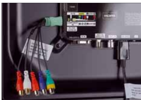
Analoge Signaleingänge wie Komponenten-Video, FBAS und Scart werden per Adapter angeschlossen
