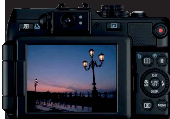
Der Monitor der G1 X ist dreh- und schwenkbar, hat eine Diagonale von 7,5 cm und löst 920.000 Punkte auf
