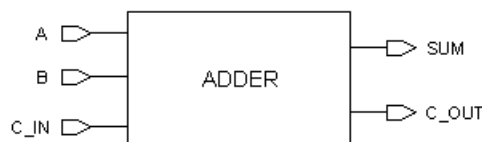
Abbildung 5-13: Blockschaltbild des Volladdierers
