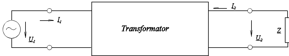
Bild EG9148A: Transformator als Vierpol
