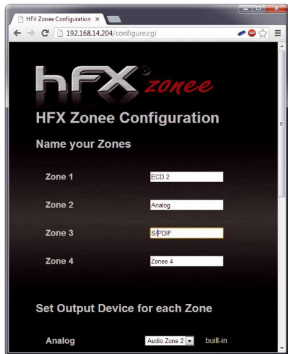
Per Webinterface lassen sich die Signalausgänge mit verschiedenen Zonen belegen
