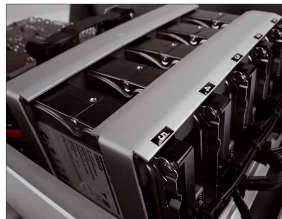
Die Festplatten wurden stabil untergebracht und sind im Betrieb nicht wahrzunehmen
