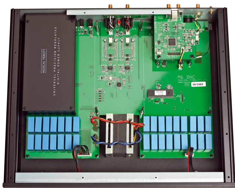
Netzteil und DAC-Bereich werden von Metalkästen abgeschirmt, die Anordnung und Verarbeitung lassen das Herz höherschlagen
