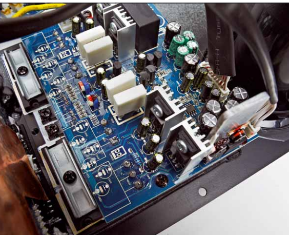
Die recht großzügige Verstärkung entpuppt sich als klassische Class-A/B-Endstufe, die Hochtöner und Tiefmitteltöner mit je einem Kanal antreibt
