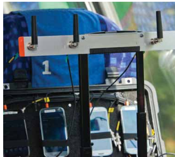
Horchposten: Vier leicht erhöht angebrachte Antennen sorgen für definierte Empfangsverhältnisse an den Mess-Smartphones.
