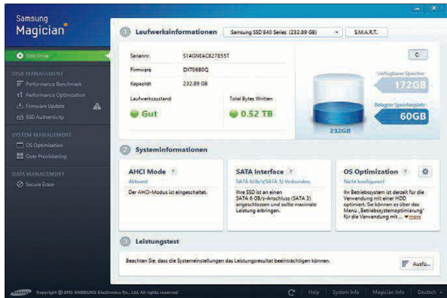
SSD Magician 4.1: Das Verwaltungs-Tool von Samsung sammelt alle wichtigen Daten zu Ihrer SSD und prüft, ob neue Firmware-Versionen vorliegen (Bild B)
