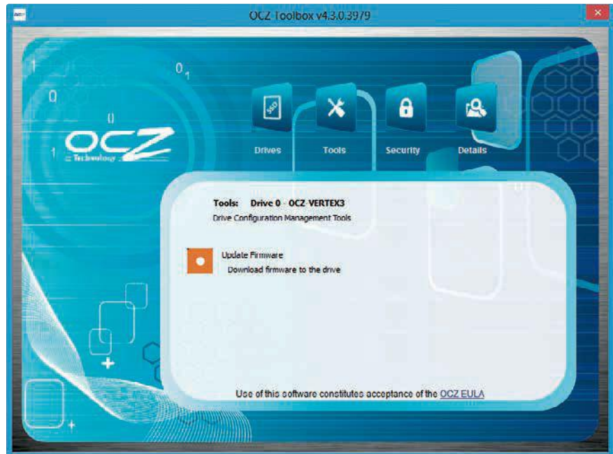
OCZ Toolbox 4.3.0: Das Programm aktualisiert die Firmware Ihrer SSD von OCZ. Klicken Sie auf das orangefarbene Symbol, um die Aktualisierung anzustoßen (Bild E)
