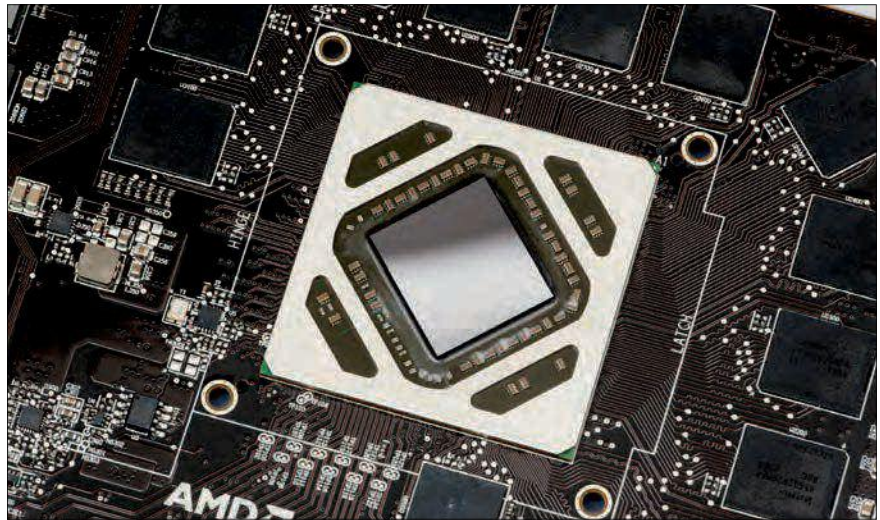
Grafikprozessor: Grafikprozessoren haben einen umfangreichen Befehlssatz. Auf Kommando färben sie Pixel, zeichnen Vierecke oder berechnen komplexe Spielwelten (Bild B)
