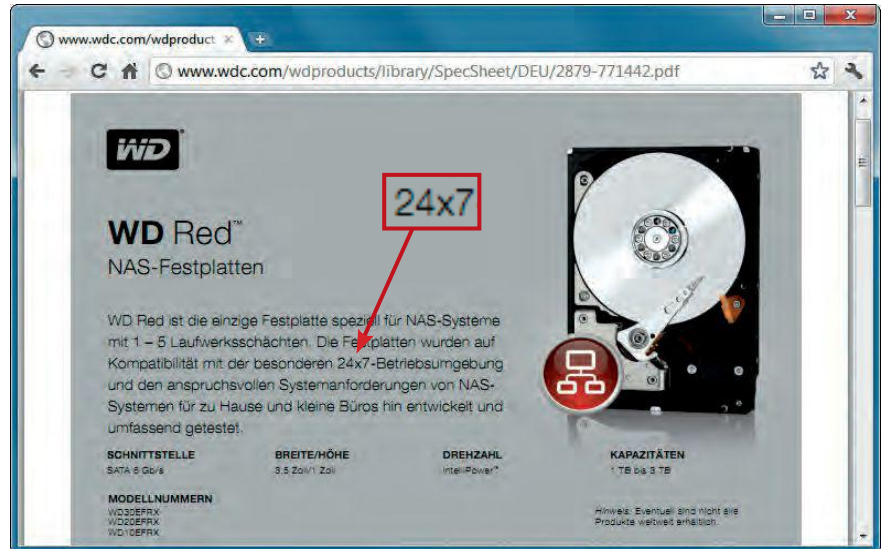
Robuste Festplattenmechanik: NAS-Festplatten sollten für den Dauerbetrieb ausgelegt sein. Sie erkennen das am Kürzel „24x7“ in der Produktbeschreibung (Bild E)
