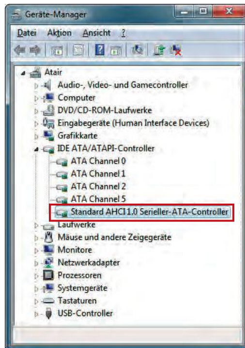
Geräte-Manager: Dieser Eintrag zeigt, dass AHCI aktiviert ist. SSDs sind damit schneller als im IDE-Modus (Bild E)
