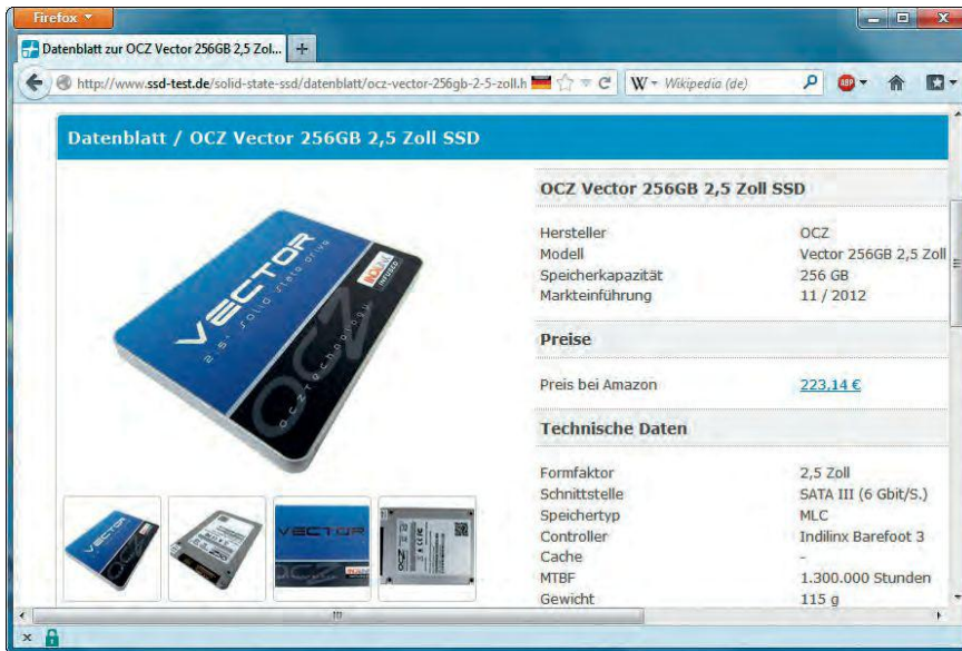
SSD-Datenbank: Hier finden Sie alle wichtigen Details wie Schnittstelle, Controller und Cache (Bild H)
