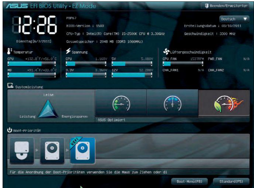
UEFI in Aktion: Der BIOS-Nachfolger ist in den meisten Fällen grafisch aufwendig gestaltet und lässt sich mit der Maus bedienen. Hier sehen Sie das UEFI des Mainboard-Herstellers Asus (Bild A)
