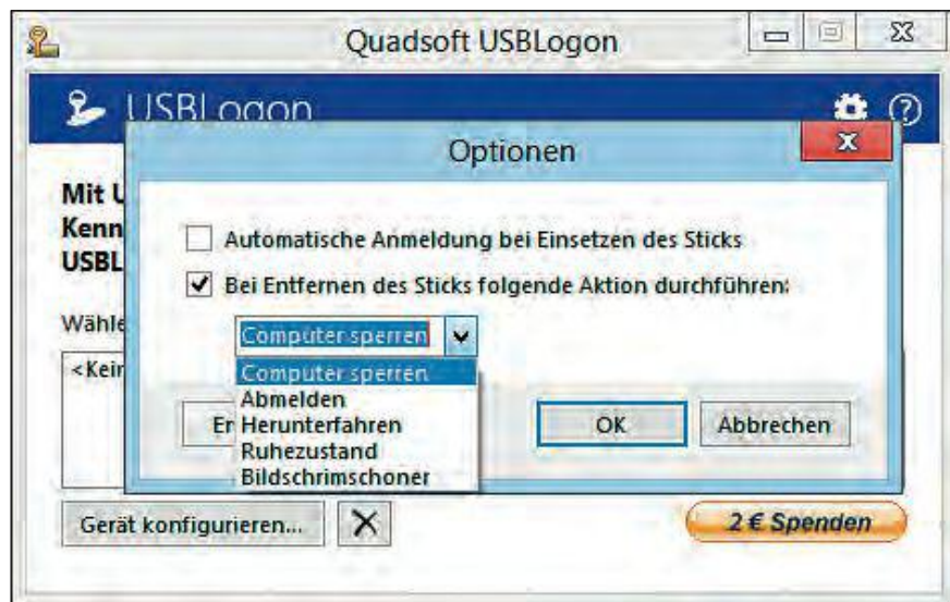
USB Logon 1.6.0.1: Hier legen Sie fest, was geschehen soll, wenn Sie den USB-Stick abziehen. „Computer sperren“ bewirkt, dass niemand den laufenden PC benutzen kann (Bild A)
