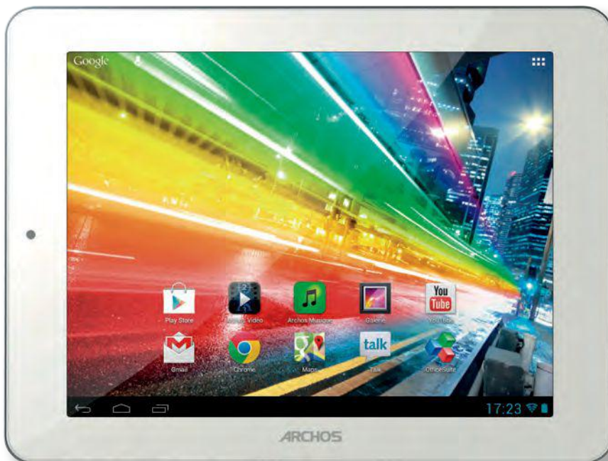
Prozessor: Bislang haben erst wenige 7-Zoll-Tablets einen Quad-Core-Prozessor mit vier Kernen, hier das neue Archos 80 Platinum (Bild H)
