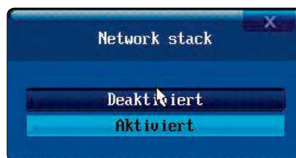
Netzwerkverbindung ohne Windows: Treiber für wichtige Hardware – etwa die Netzwerkkarte – sind bereits in UEFI integriert (Bild B)
