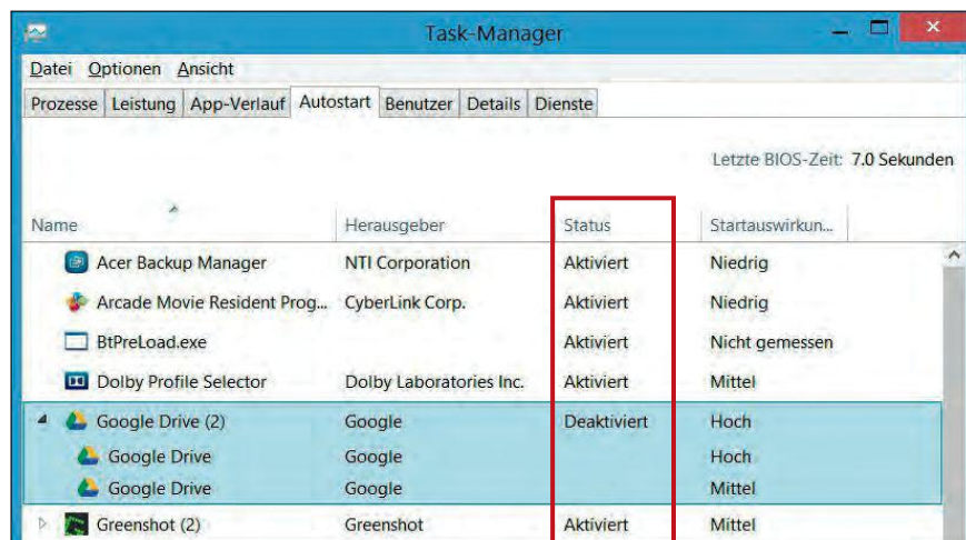
Systemstart beschleunigen: Im Task-Manager von Windows 8 lässt sich der Autostart langsamer Programme deaktivieren. Danach bootet Windows deutlich schneller (Bild E)
