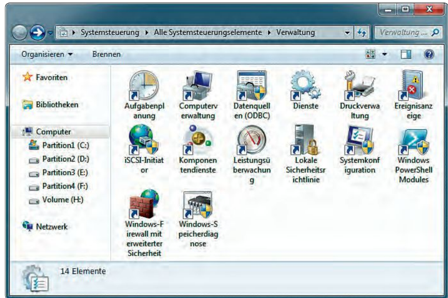
Verwaltung im Griff: Die Systemsteuerung sammelt unter „Verwaltung“ Komponenten wie „Computerverwaltung“ und „Dienste“. Den direkten Zugriff erhalten Sie mit einer Verknüpfung (Bild A)
