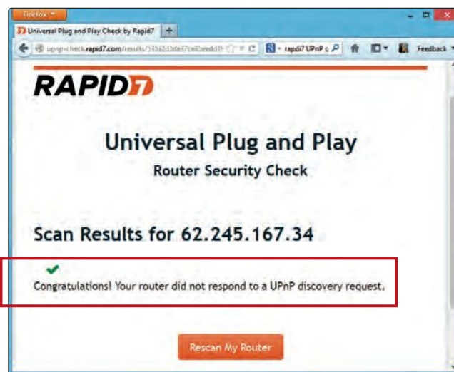
Sofort-Check bei Rapid 7: Die Router deutscher Nutzer sind in der Regel sicher – sie antworten nicht auf einen „UPnP discovery request“ von außen (Bild A)
