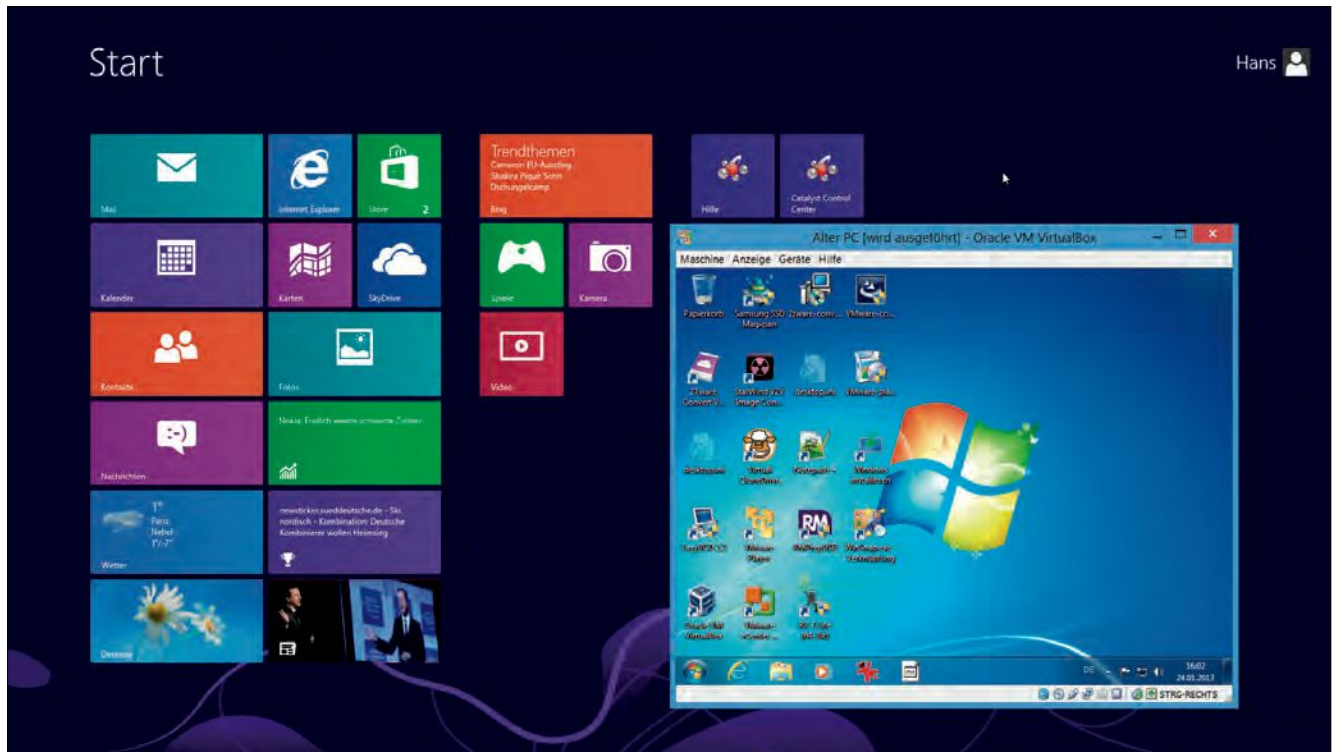
Nichts wegwerfen: Hier läuft der alte Windows-7-PC als virtuelle Maschine unter dem neuen Betriebssystem Windows 8 (Bild A)
