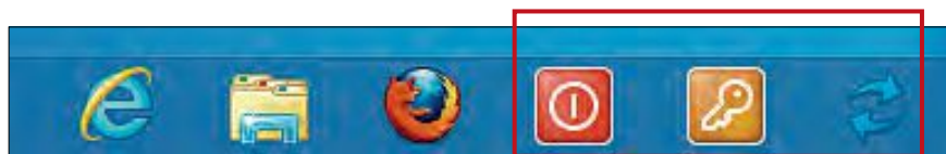
Kacheln auf dem Desktop: Die Kacheln für Herunterfahren, Ausloggen und Neustart lassen sich in der Taskleiste platzieren. Damit fahren Sie den PC mit einem Mausklick herunter oder starten ihn neu (Bild E)
