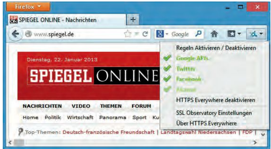
HTTPS Everywhere 3.1.2: Das Add-on wechselt wenn möglich zur verschlüsselten HTTPS-Übertragung. Die Webseite von Spiegel online unterstützt kein HTTPS, darin eingebettete Seiten hingegen schon (Bild A)
