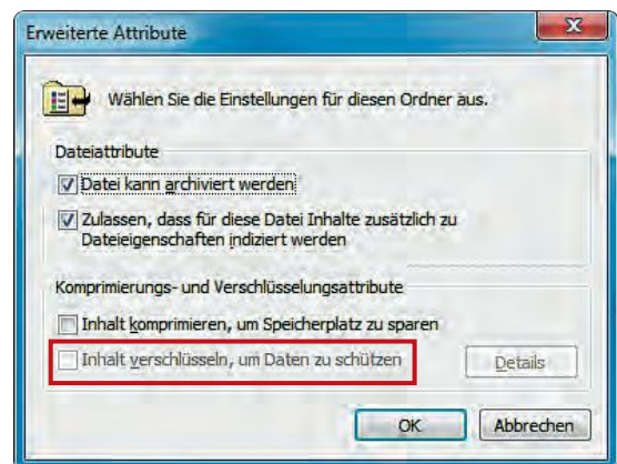
Verschlüsseln verboten: Die Option „Inhalt verschlüsseln, um Daten zu schützen“ ist nach einer Registry-Änderung deaktiviert (Bild E)
