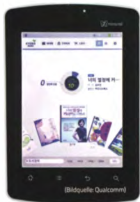
Der Buchanzeiger Kyobo e-Reader verwendet ein Mirasol-Display, das nur zum Verändern des Bildschirminhalts Strom benötigt, nicht jedoch zum Anzeigen des Inhalts.
