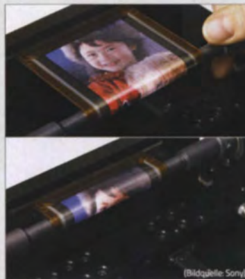
OLED-Bildschirme lassen sich so dünn und biegsam herstellen, dass man sie auf einem Bleistift aufrollen kann – sollte man dies denn wollen.
