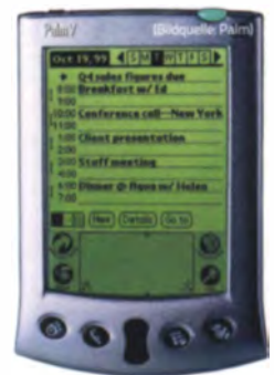
Die ersten Organizer besaßen resistive Touchscreens, die man mit einem Stift bediente. Im Bild das Modell Palm V aus dem Jahr 1999.
