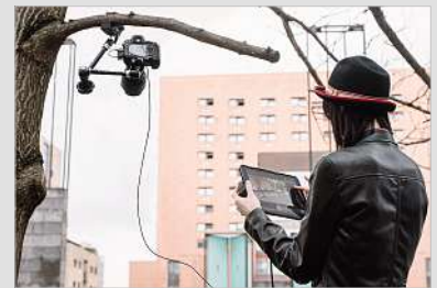
Fernbedienung: Laut Manfrotto ist bei einer Kabellänge bis maximal zehn Meter keine Signalverstärkung nötig.
