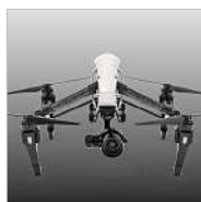
Standbeine: Das Landegestell des Inspire fährt während des Fluges nach oben.
