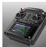
Wegpunkte: Auf dem Monitor lassen sich Wegpunkte programmieren.
